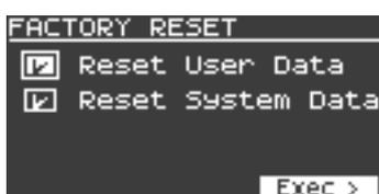
4. Wählen Sie mit den Cursor [^] [v]-Tastern den gewünschten Parameter aus und drücken Sie den [ENTER]-Taster, um die Checkbox-Markierung zu aktivieren.
